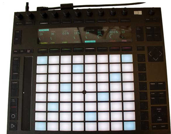
Der Ableton Push-Controller dient als Interface zur Steuerung der DAW-Software Ableton. Mit Ableton Live können Sie bis zu 16 Spuren bearbeiten. Zudem können mit dem Controller virtuelle Instrumente gespielt und aufgenommen sowie Samples in Echtzeit automatisiert bearbeitet werden.
